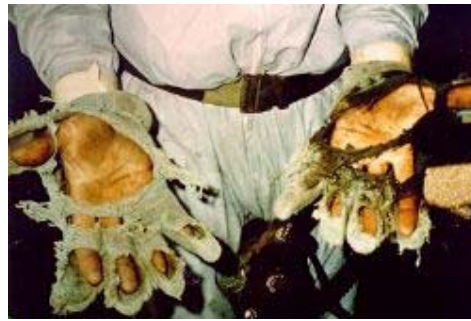
شكل (٤٠) قفازات تالفة نتيجة عدم ملاءمتها للعمل
